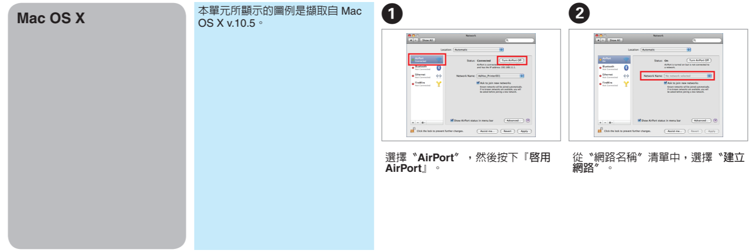
1 選擇「AirPort」，然後按下「啟用 AirPort」。 2 從「網路名稱」清單中，選擇「建立網路」。
